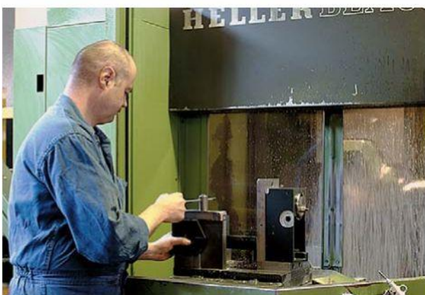
Центр CNC с устройством автоматической смены палет
