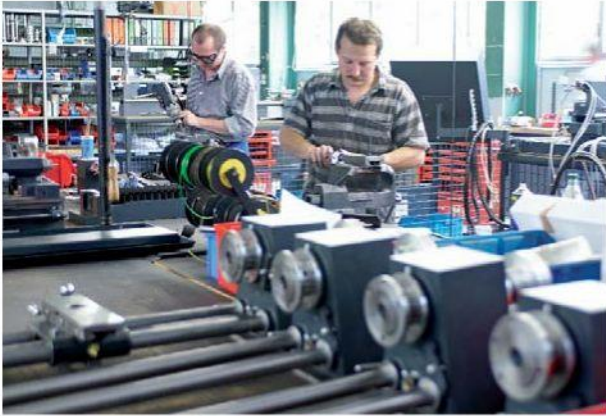
Предварит. сборка, передняя бабка D2400 E
