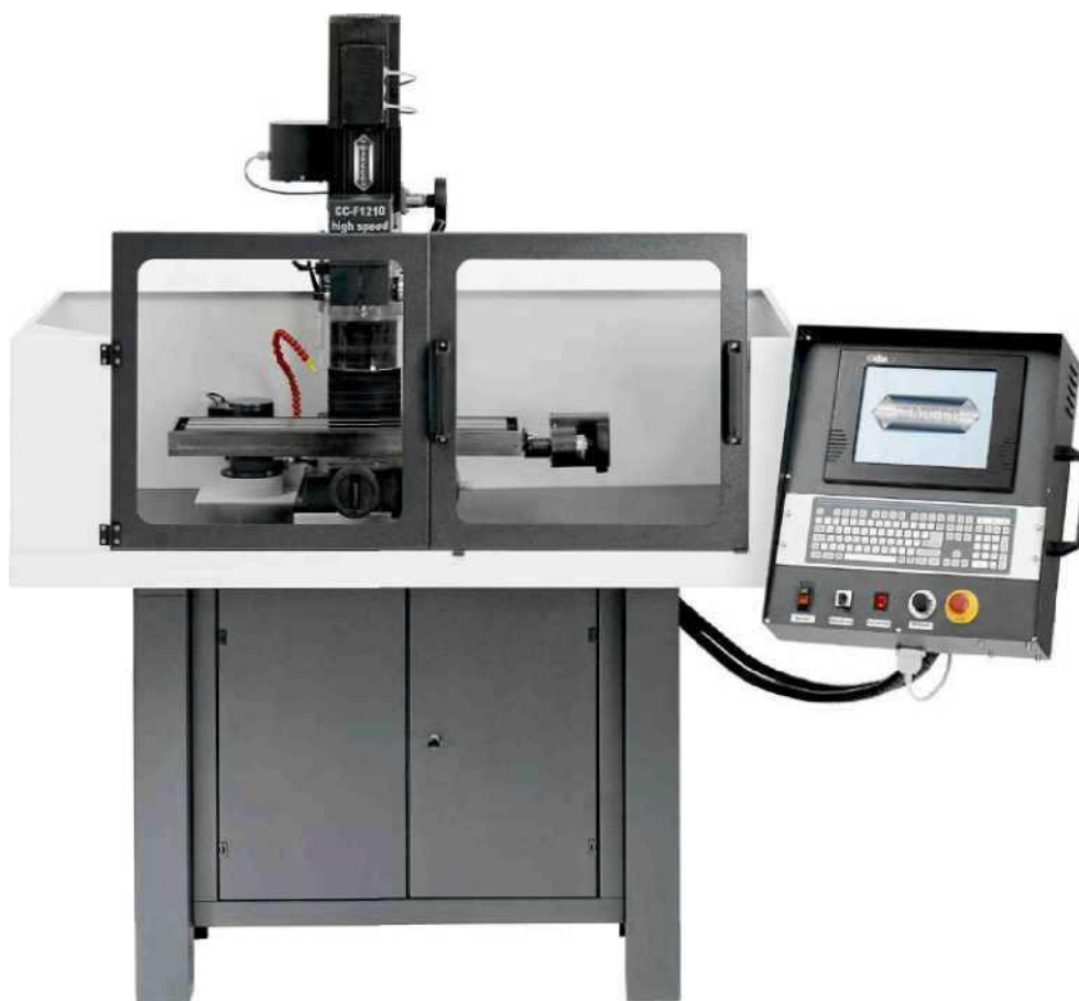
CC-F1210 E high speed с защитной кабиной и интегрированным оборудованием подачи СОЖ с защищенными монитором и клавиатурой и шкафом-подставкой
