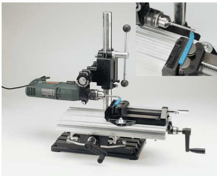
Горизонтально-расточный станок в качестве малого токарного станка
